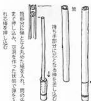
空気が圧縮され球が飛び出す
